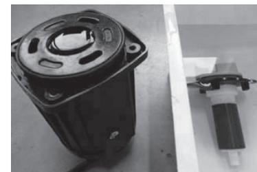
4. Placez la pompe en position verticale et remplissez-la avec un détartrant doux (comme du vinaigre ménager). Placez le rotor dans un récipient/bac plastique rempli du même produit détartrant et laissez agir durant 24 heures. Après 24 heures, rincez avec de l'eau et assemblez à nouveau la pompe
